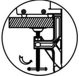
2. Ослабьте пробойник и шплинт, установите рабочую поверхность на наковальне , затем зафиксируйте рабочую поверхность и согласующее устройство при помощи пробойника. Застопорите все при помощи шплинта.
